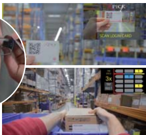
Com o Vision Picking, as informações de cada tarefa durante o processo de retirada de materiais, incluindo o corredor, a localização do produto e a quantidade desejada, são mostradas nos óculos inteligentes
